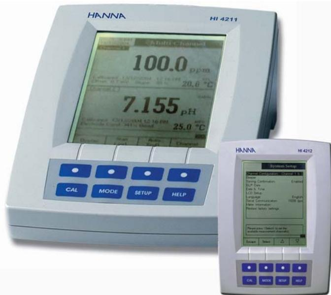
Per avere misure sempre accurate è necessario prestare grande attenzione alla calibrazione dello strumento: infatti è proprio durante la calibrazione che il sistema strumento più elettrodo acquisisce i valori utili a costruire una retta di taratura interna da utilizzare come riferimento in fase di misura. Ovviamente maggiori sono i punti di interpolazione per la costruzione di tale retta e maggiore sarà la vicinanza al comportamento reale delle soluzioni.
