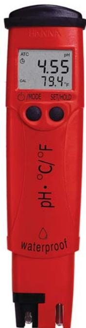
Questi due nuovi strumenti rappresentano una innovazione nel campo dei pHmetri tascabili. Infatti, pur con le loro dimensioni compatte, hanno tutte le caratteristiche funzionali e la precisione di uno strumento professionale. Inoltre sono robusti, a tenuta stagna e perfettamente galleggianti, in caso di caduta accidentale nell'acqua. Sono quindi ideali sia per il tecnico di laboratorio esigente, che per chi desidera uno strumento completo ma anche semplice da usare per le misure sul campo.
